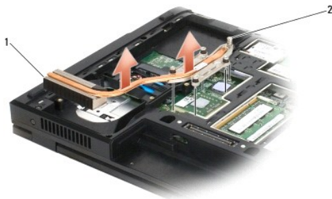
1 E5500 processzor hűtőborda 2 rögzítőcsavarok (5)
